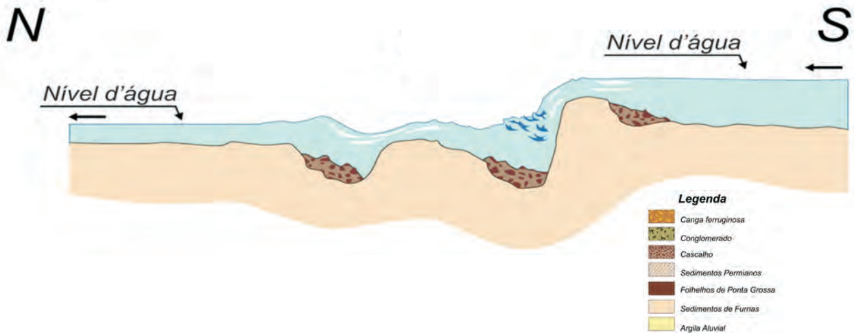
Figura 5 – Perfil longitudinal do rio Tibagi, num dos garimpos conhecido como Mato Bom a montante do município de Tibagi, ilustrando o entendimento, à época, das armadilhas de relevo para os depósitos diamantíferos (baseado em Oppenheim, 1936).
