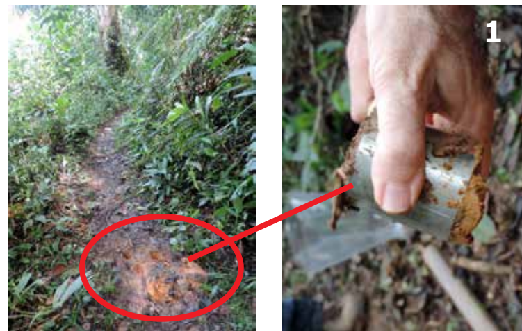
Figura 1. Trilha Praia da Lagoa-Praia do Simão. Em vermelho mostrando coleta pelo anel volumétrico. Foto: Maria do Carmo Oliveira Jorge
